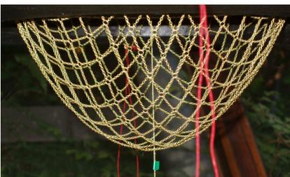
Fig. 7. Red catenaria colgada para obtener la forma antifunicular de una bóveda de celosía apoyada en todo su perímetro.
