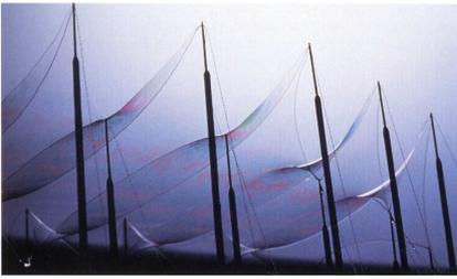
Fig. 4. Superficie ondulada formada por ejes paralelos alternando crestas y valles. Maqueta realizada con películas de jabón en el Instituto de Estructuras Ligeras de Stuttgart.
